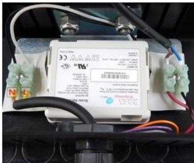
[FIG.2] Collegamento cavo alimentazione
