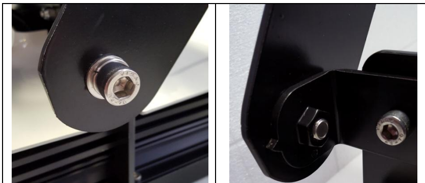
[FIG.4] Fissaggio tilt apparecchio - Coppia di serraggio viti M10 40÷60 Nm.
