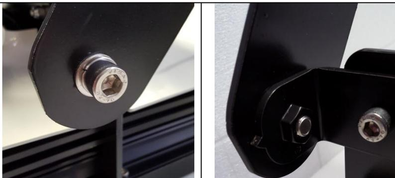
[FIG.6] Fissaggio tilt apparecchio - Coppia di serraggio viti M10 40±60 Nm.
