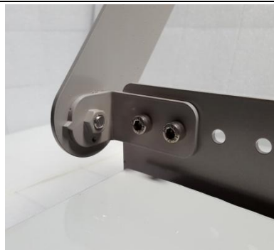
[FIG. 6] Fissaggio inclinazione apparecchio - Coppia di serraggio viti M10 40÷60 Nm.
