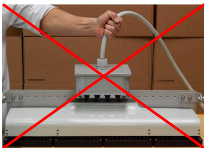
[FIG. 7] Non sollevare l'apparecchio con il cavo per evitare danni al pressacavo.
