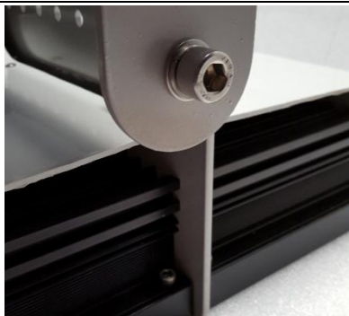
[FIG. 6] Fissaggio inclinazione apparecchio - Coppia di serraggio viti M10 40÷60 Nm.
